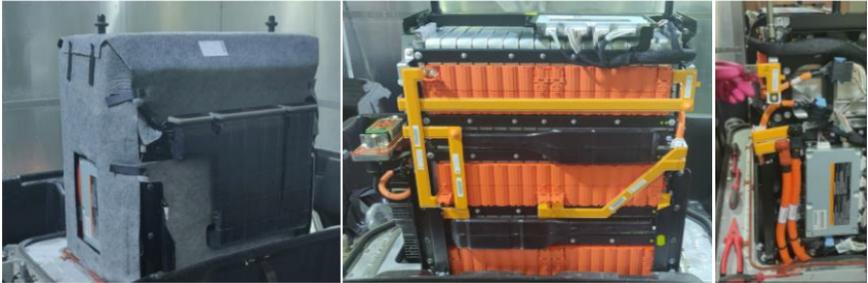
Manuelle Demontage des Batteriepacks aus dem Renault Fluence\*
